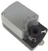
Этот компактный, безрессорный возвратный привод имеет вращающий момент 4 Нм в компактном, легком в установке корпусе. Он имеет номинальное время прогрева в 35 секунд для вращения на 90°.
